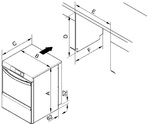
Damit die Maschine im eingebauten Zustand leicht in der Höhe ausgerichtet werden kann, empfehlen wir die Montage auf 3 Stellfüßen
