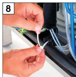
8 Zur Zugentlastung die Netzanschlussleitung mit einem Kabelbinder an der Montageplatte befestigen.
